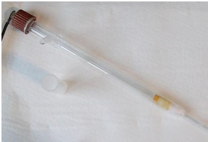
Abb. 10. Quarz-Reaktor v.l.n.r.: Quarz-Transducer, Kappe mit Dichtung, Quarzverbindungsstab innen und Reaktorrohr mit Gaseinlass außen,  $V_2O_5$ -Sinterstab, Quarzwolle, Gasauslass
