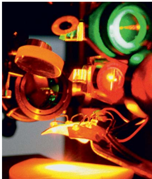
Abb. 2 Experimenteller Aufbau für die Mikroanalyse von mineralischen Proben mittels LIBS und Raman-Spektroskopie.
