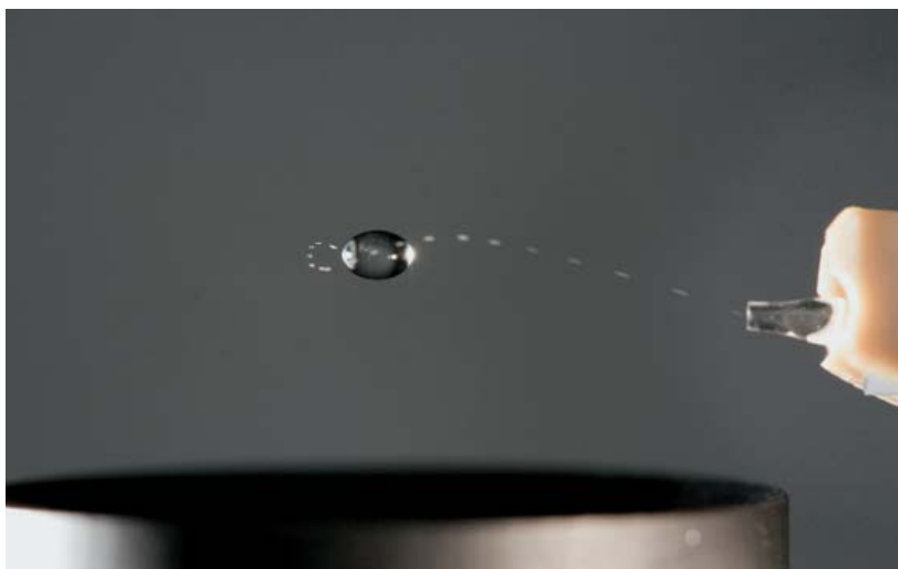
Abb. 3 Einem schwebenden Wassertropfen in einer Ultraschallfalle wird ein Reagens mit einem pL-Tropfen durch einen piezoelektrischen Tropfengenerator zugeführt.
