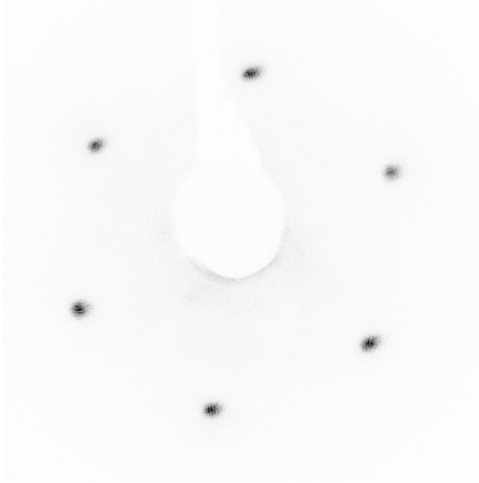
Abbildung 6.1: LEED-Bild der sauberen Cu(111)-Oberfläche mit E_{\text{kin}} = 144 \text{ eV} und T = 115 \text{ K} . Klar zu erkennen ist die hexagonale Struktur des Oberflächengitters.
